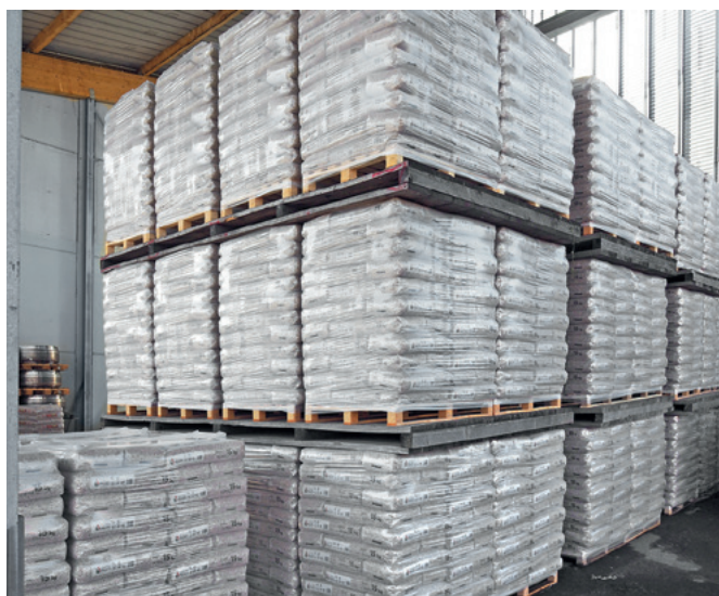
Trotz der sehr dünnen Stärke von 60 µm lassen sie die Paletten problemlos mehrfach übereinander stapeln
